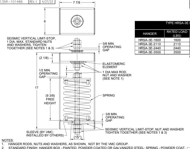
TYPE HRSA-3E ELASTOMERIC & SPRING ANGULARITY HANGERS FOR 3" NOMINAL DEFLECTION DEFLECTION | SPRING RATE **SPRING** ELEMENT COLOR CODE COLOR CODE RE-D-1900-GREEN 3.00 533 DK GRAY 2.53 833 **DK YELLOW** RE-D-3050-GRAY RED 2.44 1000 RE-D-3050-GRAY 2.63 1333 **GREEN** RE-D-4200-BLUE
